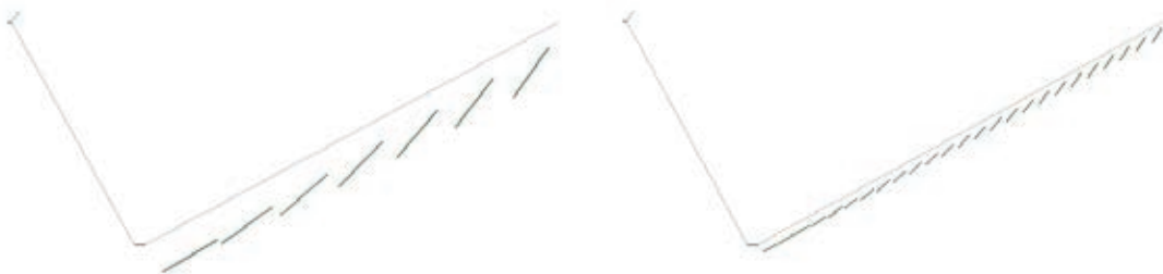
Figuur 9. Het draaipunt van brede lamellen (links) bevindt zich op een grotere afstand van de ruit dan het draaipunt van smalle lamellen. Door randeffecten kan dit de concentratie-efficiëntie beïnvloeden.
