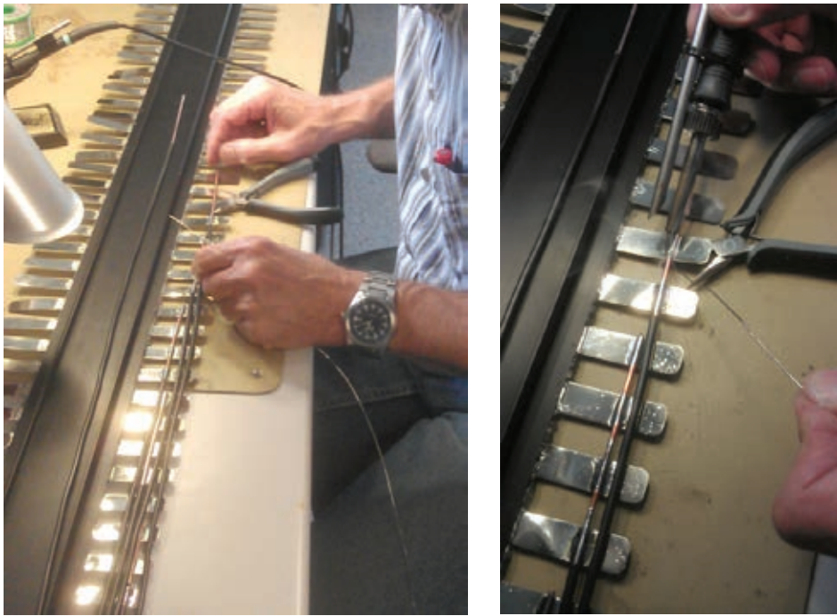
Figuur 50. Bedrading van de CPV-modules door Wageningen UR Glastuinbouw
