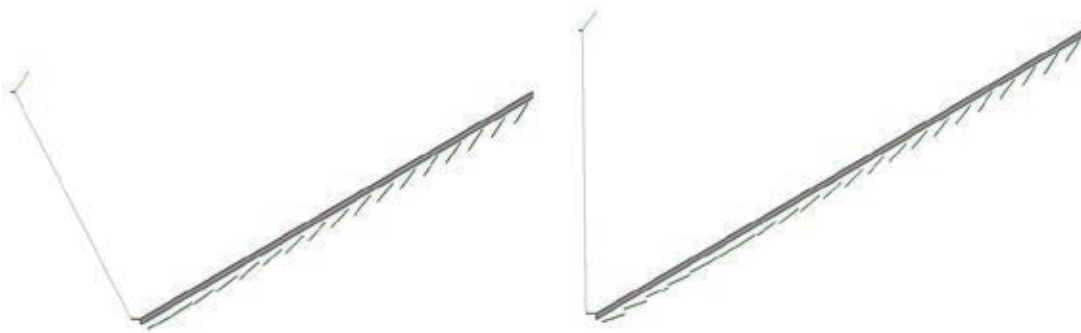
Figuur 19. Zaagtand-dak (rechts) in vergelijking met de Elkas uit fase I (links), bij een kapbreedte van 4 m. Beide hebben een dakhelling van de zonzijde van 30 en een lamelbreedte van 193 mm. Bij een gelijke kapbreedte heeft het zaagtand-dak een nok die 498 mm hoger ligt.
