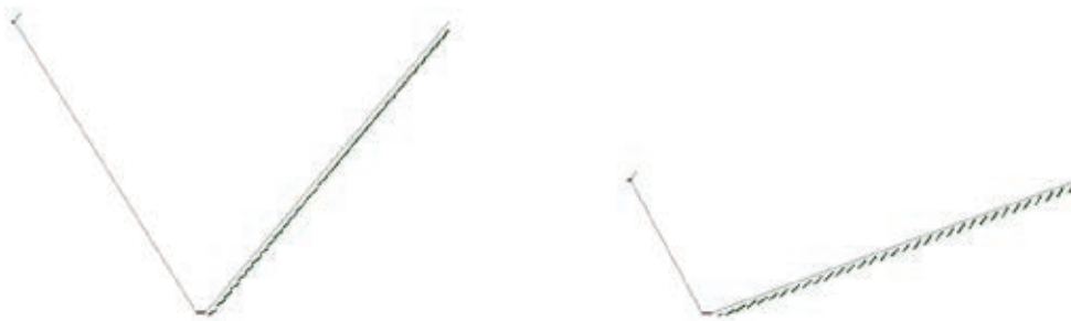
Figuur 16. Zuidzijde dakhellingen van 50° (links) en 20° (rechts) bij een lamelbreedte van 100 mm en een oppervlaktefractie van 0.866 (Analoog aan gerealiseerde Elkas uit fase I)
