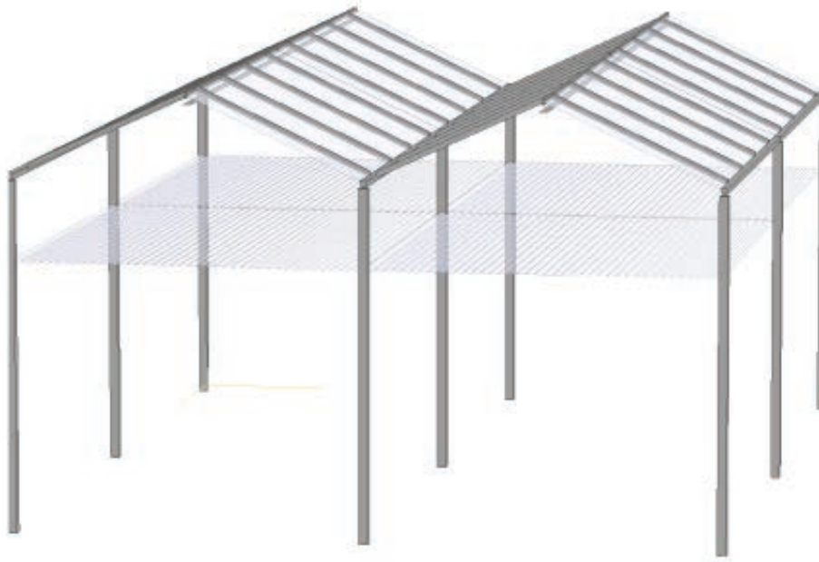
Figuur 21. Elkas met horizontale lamellen over de gehele kapbreedte en een CPV-module onder of geïntegreerd in de nok. Om een gunstige hoek te creëren tussen de lamellen en de CPV-module is een zekere ruimte tussen de lamellen en de goot nodig.
