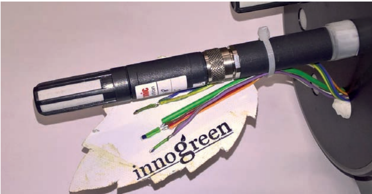
Figuur 3.3 Foto van temperatuurvoelers samen met de Rotronic sensor, waarmee de PT-100 die tegen het kunstblad was geplakt is geijkt.
