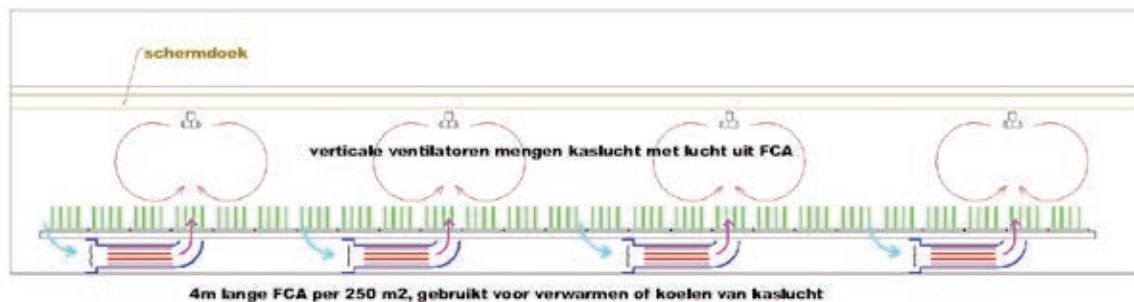
Figuur 2.2. Principe FCA systeem voor gesloten kas.
