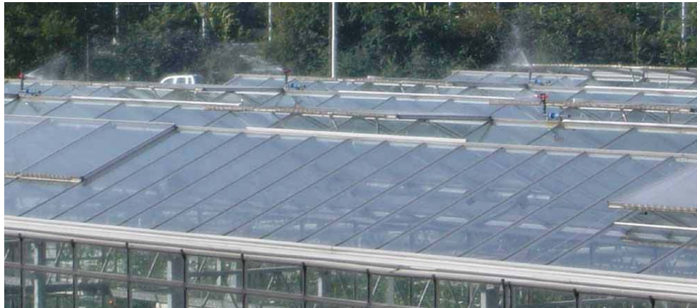
Figuur 2-6 Experiment met dakbevloeiing door middel van standaard beregeningssproeiers.
