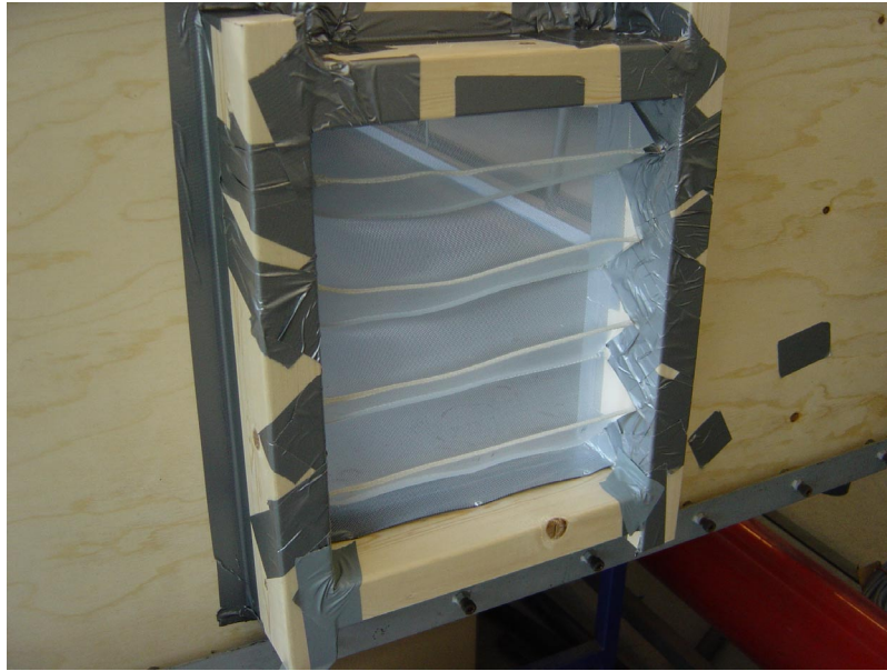
Figuur 3. Bevestiging van een Holland Gaas in het meetschot.
