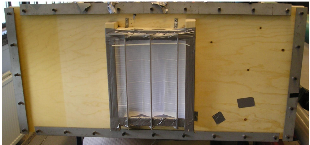
Figuur 4. Bevestiging van een Markies Venlo-gaas in het meetschot.
