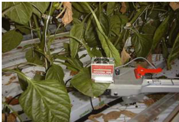
Figuur 1. De mobiele meetapparatuur (bladkamer) voor de meting van fotosynthese, ademhaling en verdamping. Foto gemaakt bij paprikateler Van der Burg te Est, juli 2004.
