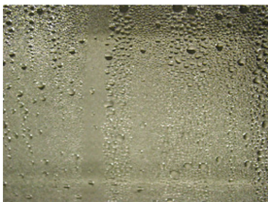
Figuur 32. Detailfoto condensatiegedrag tijdens onderzoek in het lab van standaard glas (links) en AR glas (rechts).
