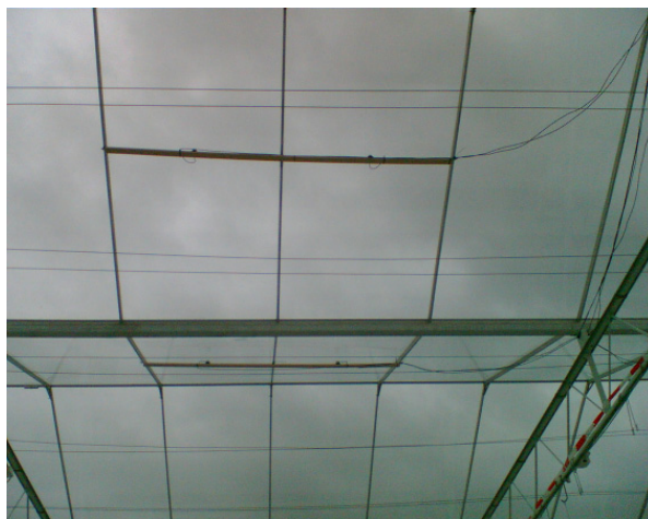
Figuur 6. Foto van de meetopstelling in het dak in de kas bij van der Lans. Hier meetopstelling in vak gedekt met gewoon glas, twee sensoren horizontaal onder de middelste ruiten aan de Noordkant en twee aan de Zuidkant.
