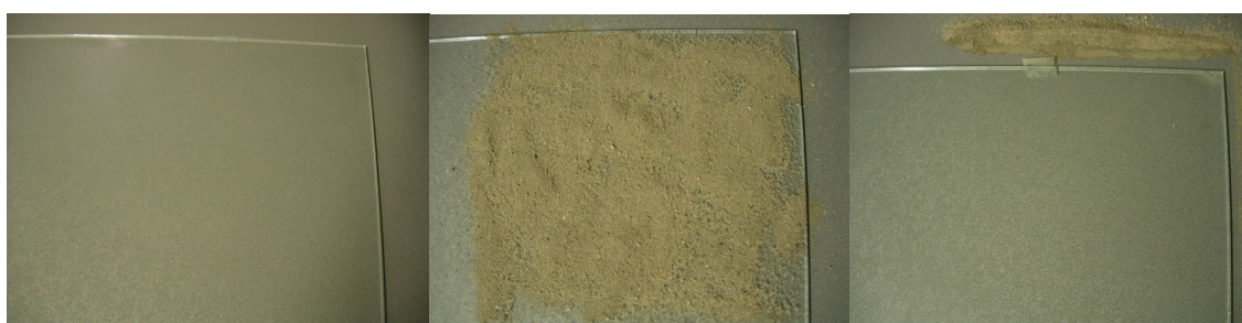
Figuur 56. Methode van nabootsing vervuiling van het glas, Schoon (links), met zand bevuild (midden), zand afgeblazen met lucht (rechts), ten slotte afgespoeld met water (geen foto).
