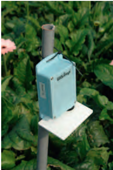
Figuur 3.2. Wysensis draadloze meetbox zonder ventilator.
