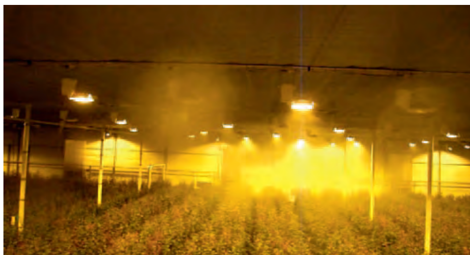
Figuur 3.24. Rook trekt boven scherm richting gevel en zakt dan door de kieren omlaag.
