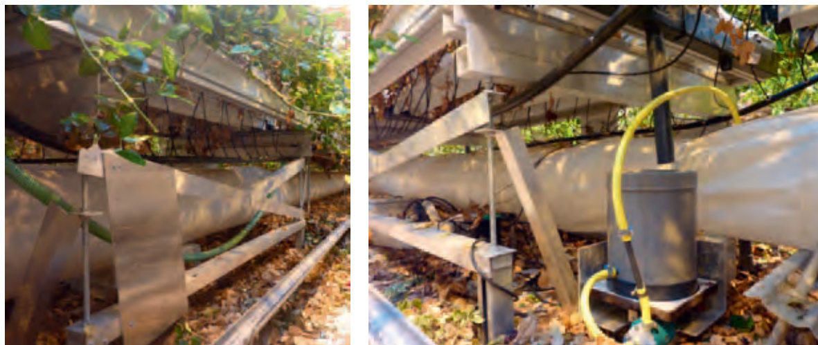
Figuur 5.3. Weegunit met frame waarop loadcells en goten die uitmonden in drainopvang.
