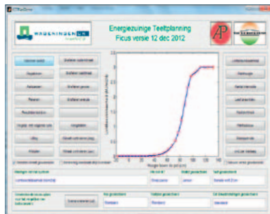
Figuur 3.4. Berekende lichtgradiënt in het gewas aan het eind van de teelt, afhankelijk van de hoogte boven de pot (cm). Door de hoge LAI (Figuur 3.3.) dringt er onder in het gewas vrijwel geen licht meer door (zelfde teelt als in Figuur 3.1.).
