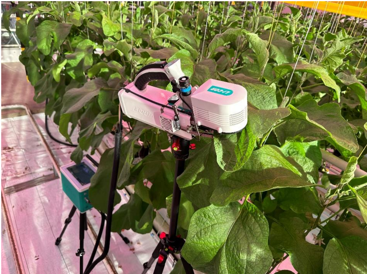
Figuur 3-1. De LI-6800 draagbare fotosynthesemeter in de auberginekas. In de meetcuvet kunnen PAR, \text{CO}_2 , temperatuur en vocht worden gevarieerd. Er is gekozen om te meten bij 200 \mu\text{mol}/\text{m}^2/\text{s} PAR en een vast \text{CO}_2 -gehalte van 800 \text{ ppm} en temperatuur en vocht met de kasomstandigheden mee te variëren over de dag heen.
